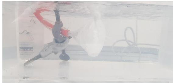
Figure 18 Bulleur fabriqué avec un entonnoir
