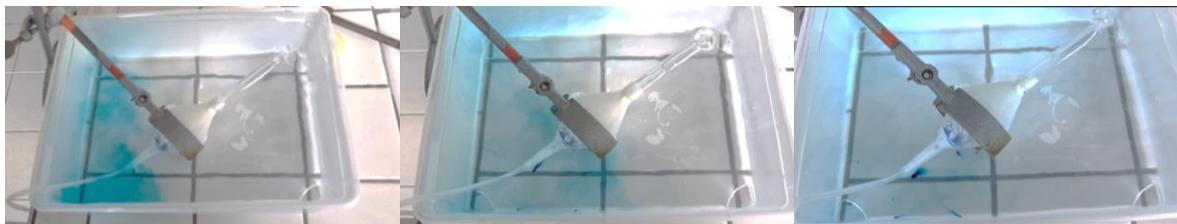
Figure 20 Test de renouvellement de l'eau avec du bleu de méthylène à 3 temps
