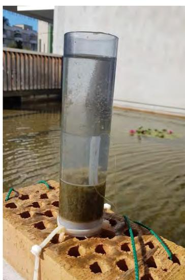
Figure 15: Contenu piégé dans un piège à sédiments.
