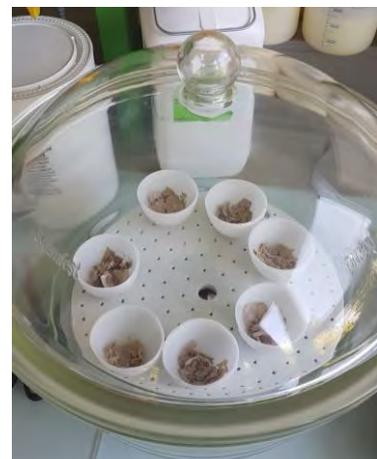
Figure 18: Creusets avec sédiments incinérés dans le dessiccateur.
